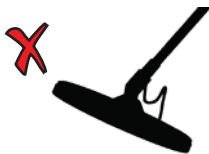
Неправильный угол наклона
