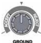
С помощью этого регулятора Вы можете подкорректировать влияние земли и более точно отсечь железосодержащие минералы или любые другие остатки керамики, содержащие окислы железа.
